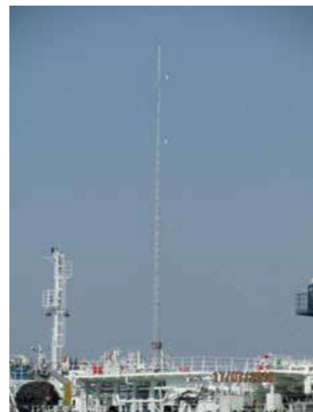
Рисунок 2 – Мачта с датчиками МК-15, установленная на ПлВП головного заказа проекта 23130
