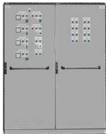
Центры управления электроприводами предназначены для прямого пуска и остановки, местного или дистанционного управления асинхронными электроприводами, защиты ЭД от перегрузки по току, защиты ЭД от обрыва питающей фазы и исчезновения напряжения в сетях переменного тока напряжением до 690 В и частотой 50/60 Гц.
